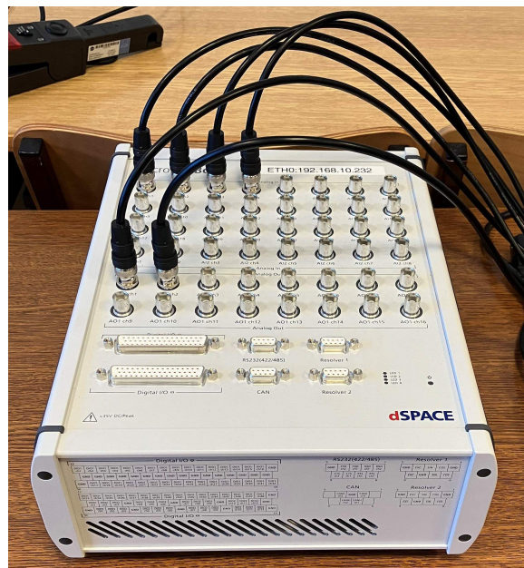
SL. 3.8: dSpace-ov MicroLabBox stvarnovremenski simulator
