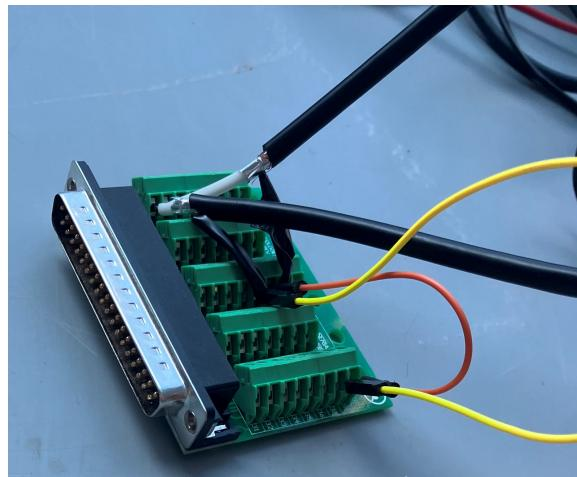
**SL. 4.3:** Negativni priključci spojeni na uzemljenu točku
