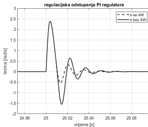
**SL. 2.11:** Regulacijska odstupanja pri limitu od 8 Nm
