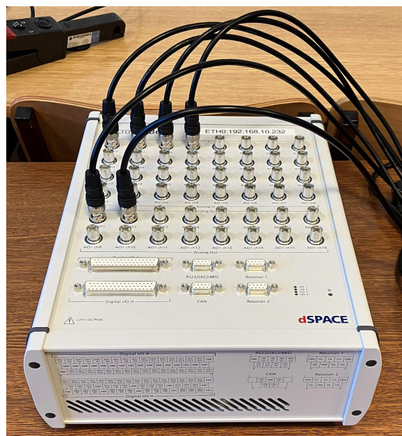
SL. 3.8: dSpace-ov MicroLabBox stvarnovremenski simulator
