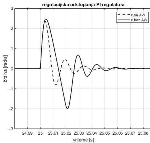
**SL. 2.13:** Regulacijska odstupanja pri limitu od 7 Nm
