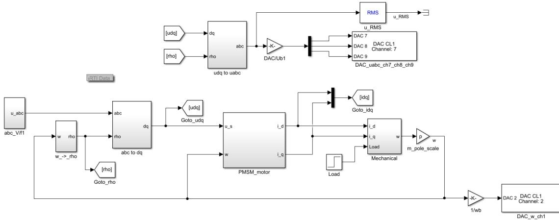
**SL. 3.23:** Simulink model PMSM-a sa skalarnim upravljanjem
