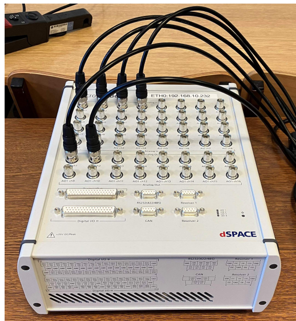
SL. 3.8: dSpace-ov MicroLabBox stvarnovremenski simulator
