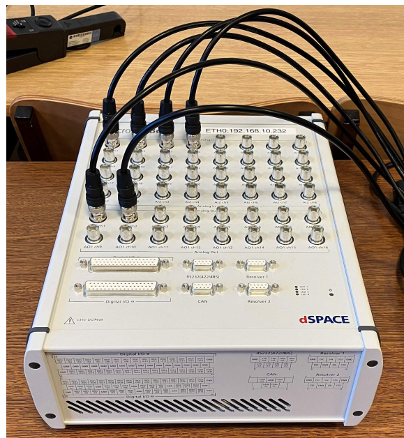
SL. 3.8: dSpace-ov MicroLabBox stvarnovremenski simulator
