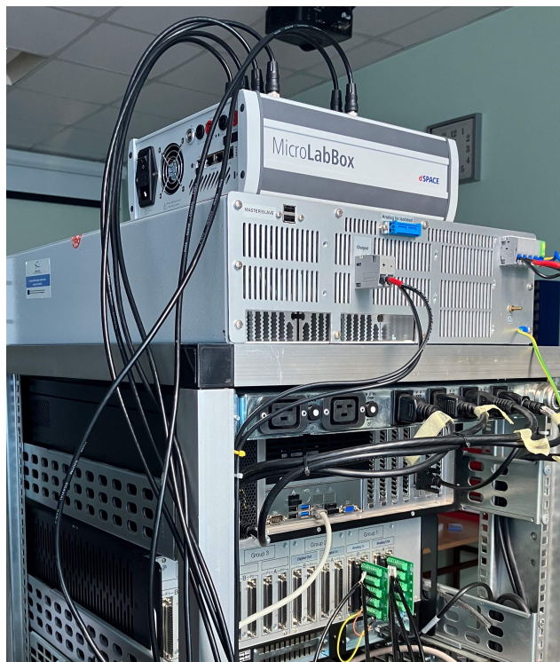
SL. 4.1: OP5031 i OP5600 povezani sa MicroLabBox-om u kosimulaciju
