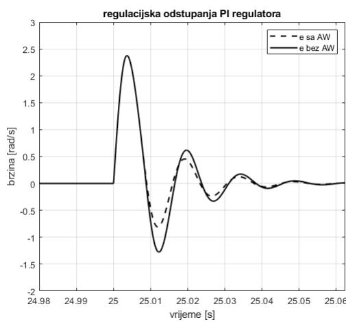
SL. 2.9: Regulacijska odstupanja pri limitu od 9 Nm
