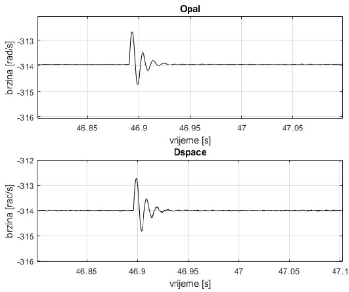
**SL. 4.17:** brzina motora za vrijeme rasterećenja
