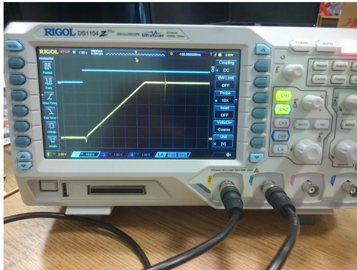
**SL. 3.25:** Graf brzine snimljen na osciloskopu
