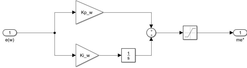
**SL. 2.6:** Model regulatora sa zasićenjem
