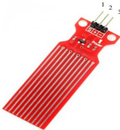
Slika 2.7. Senzor za detekciju vode
