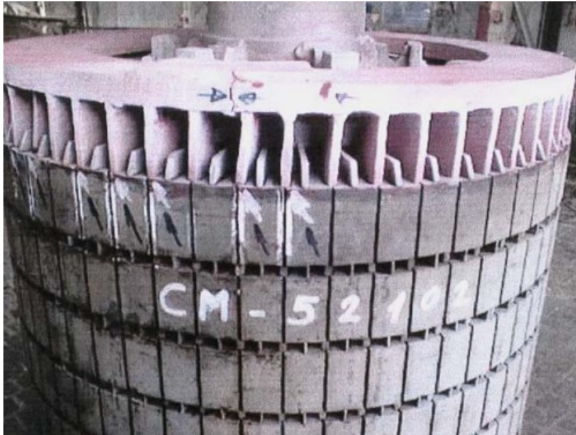
Slika 4.6 Detekcija pukotina pomoću penetranta [2]
