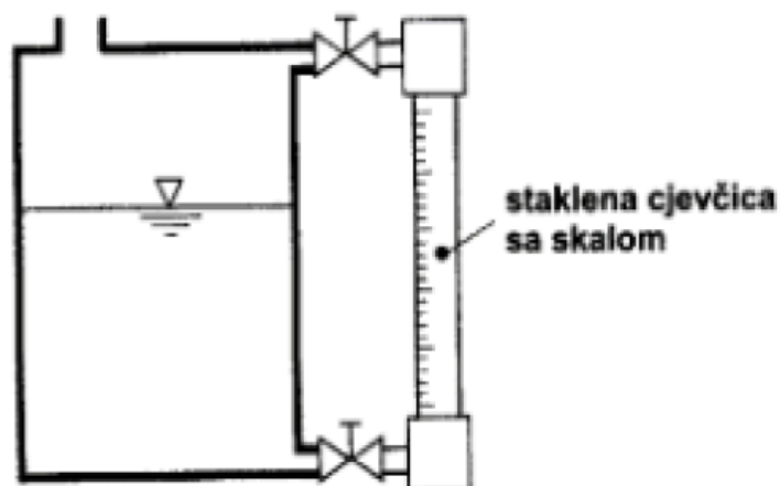
Slika 2.1. Prikaz uređaja za mjerenje razine staklenom cjevčicom (Bypass) [2]
