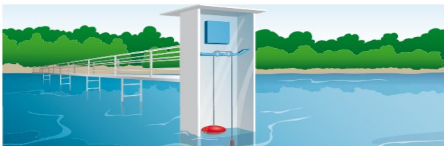
Slika 2.3. Primjena mjernila s plovkom [17]
