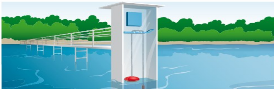
Slika 2.3. Primjena mjernila s plovkom [17]
