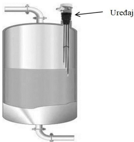
Slika 2.8. Prikaz konduktivnog mjerenja razine [4]
