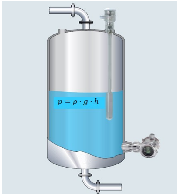
Slika 3.2. Hidrostatsko mjerenje razine u otvorenom spremniku [7]
