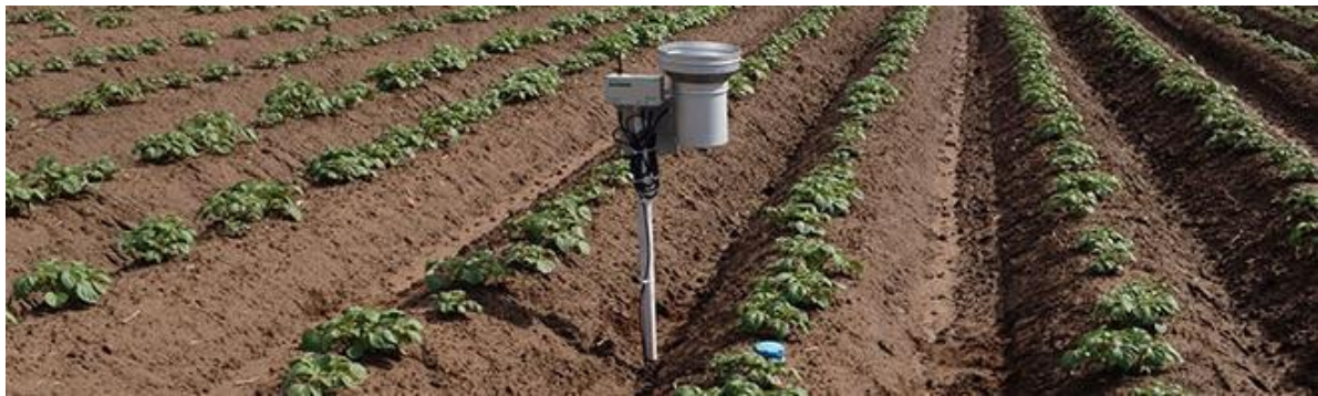
Slika 6.2. Senzor temperature i vlage
