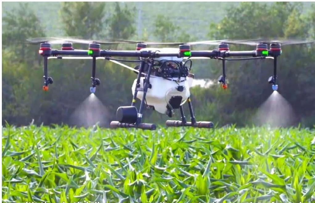
**Slika 5.10** Bespilotna letjelica za raspršivanje pesticida
