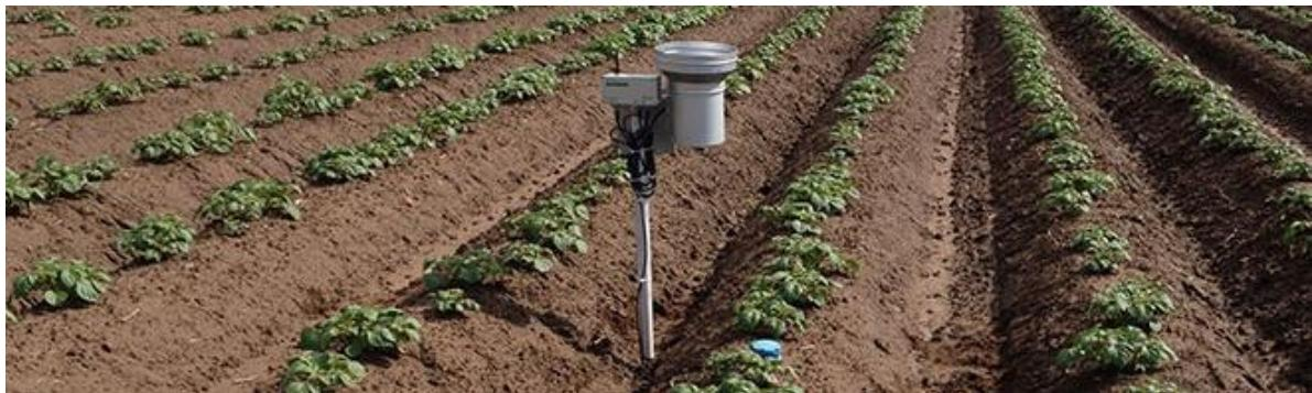
**Slika 6.2.** Senzor temperature i vlage
