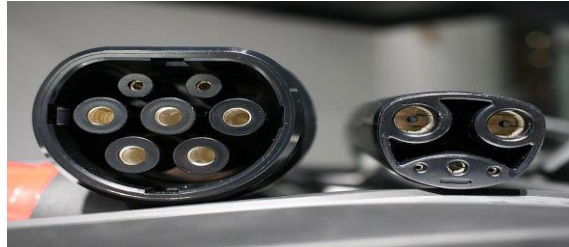
Slika 5.6 Prikaz priključaka tvrtke TESLA – desno (Američko tržište), lijevo (Europsko tržište)[32]
