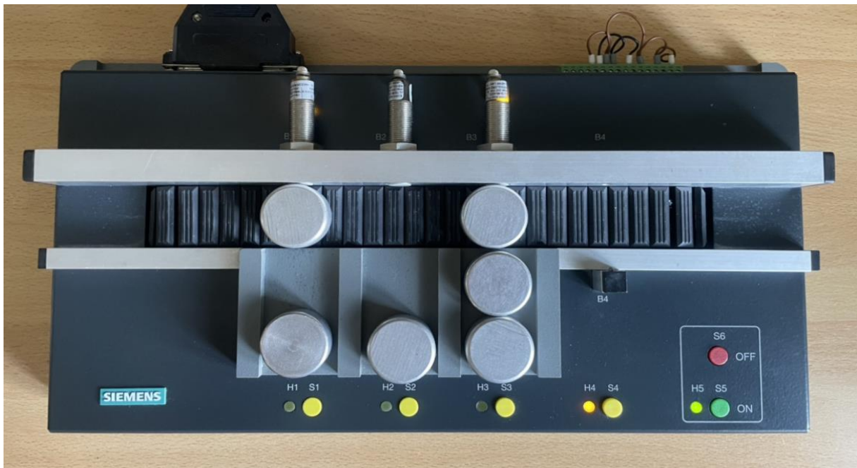
Slika 4.11 Pokretna traka – Status alarm H4
