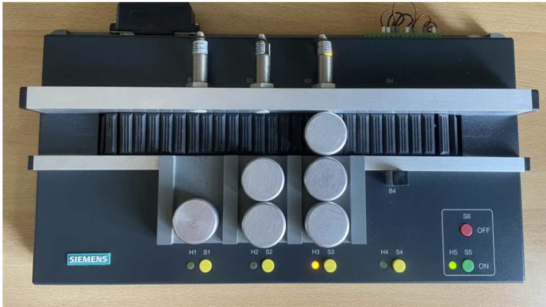
Slika 4.7. Pokretna traka – Status montažno mjesto H3
