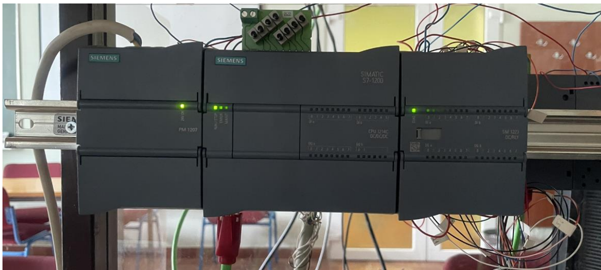
Slika 3.11 Modul napajanja, PLC S7 1200, U/I Signalni modul potrebni za realizaciju praktičnog dijela diplomskog rada
