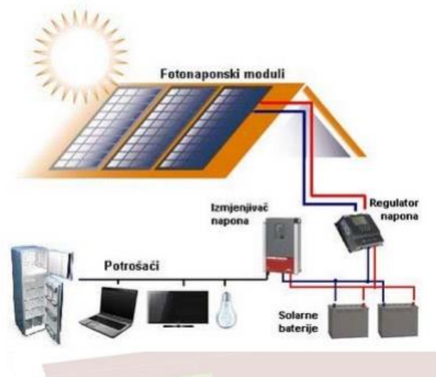
Slika 3.1.3. Samostalni fotonaponski sustav [28].
