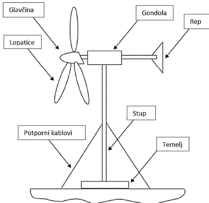
**Slika 3.11** Prikaz osnovnih dijelova male vjetroturbine [20]
