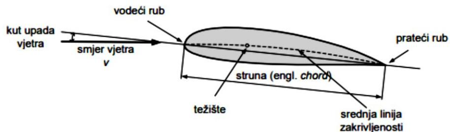
Slika 3.7 Poprečni presjek lopatica vjetroturbine [11]
