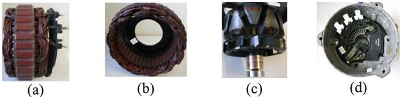
Slika 6.6 Standardni dijelovi automobilskeg alternatora sa kandža kavezom na rotoru; (a) i (b) stator sa zubcima i utorima, (c) rotor, (d) energetskeg elektronika [21]
