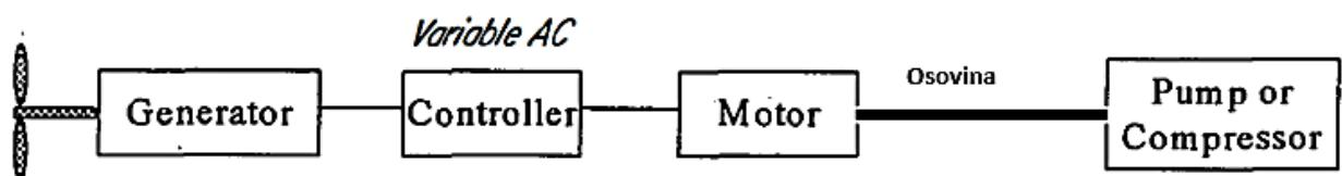
Slika 3.17 Elektrifikacija vjetrom; promjenjivo AC opterećenje [18]
