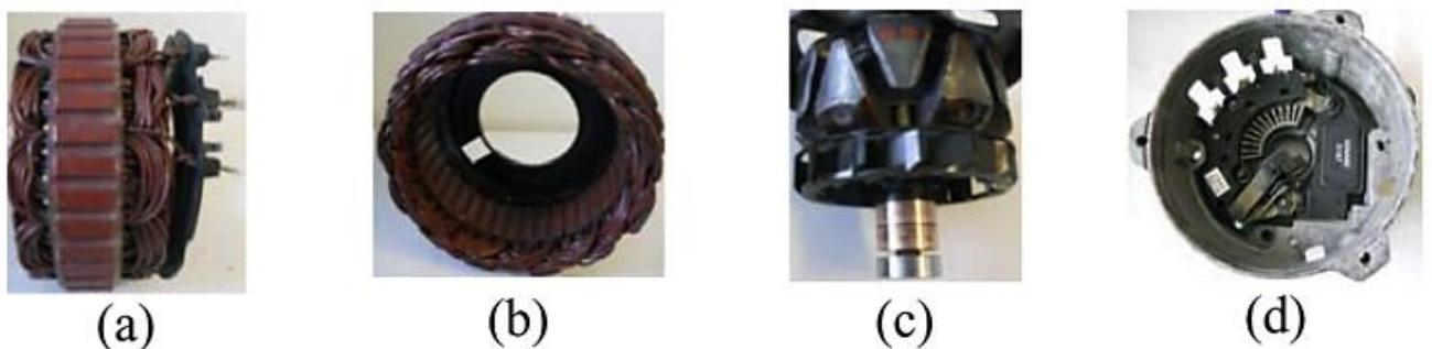
**Slika 6.6** Standardni dijelovi automobilskog alternatora sa kandža kavezom na rotoru; (a) i (b) stator sa zubcima i utorima, (c) rotor, (d) energetska elektronika [21]
