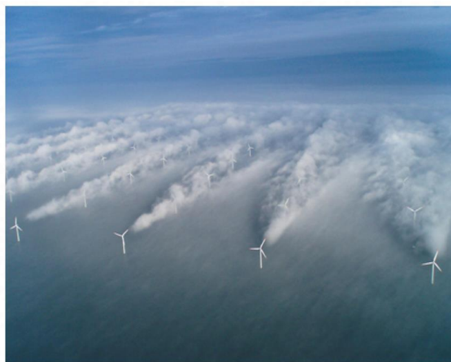
Slika 3.26 Efekt zavjetrine, vjetroпарк na pučini [11]
