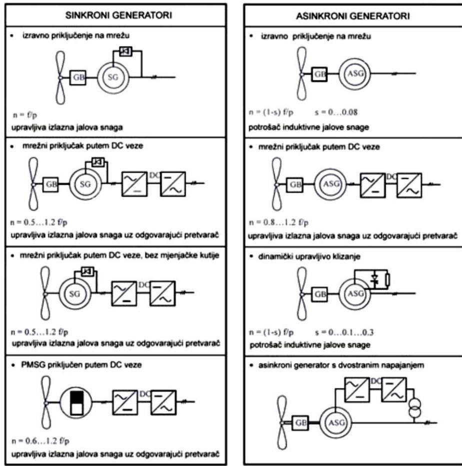
Slika 3.9 Izvedbe asinkronih i sinkronih generatora u vjetroturbinama [11]
