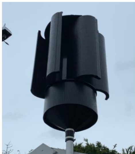
Slika 3.22 Alpha 311 Mk.X vjetroagregat
