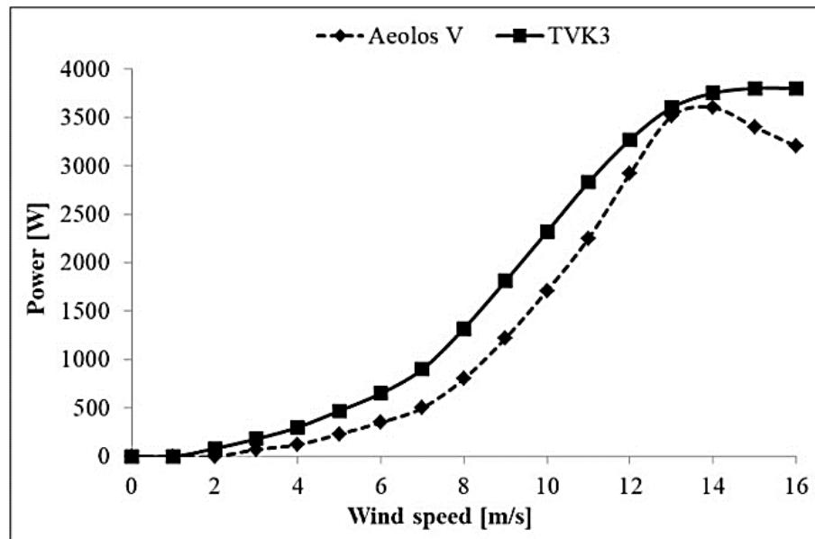
**Slika 6.17** Krivulje snage dvaju analiziranih turbina [23]
