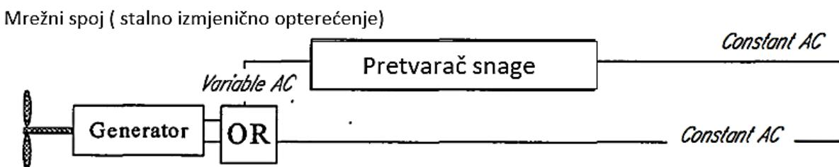
Slika 3.16 Mrežni spoj; stalno AC opterećenje [18]
