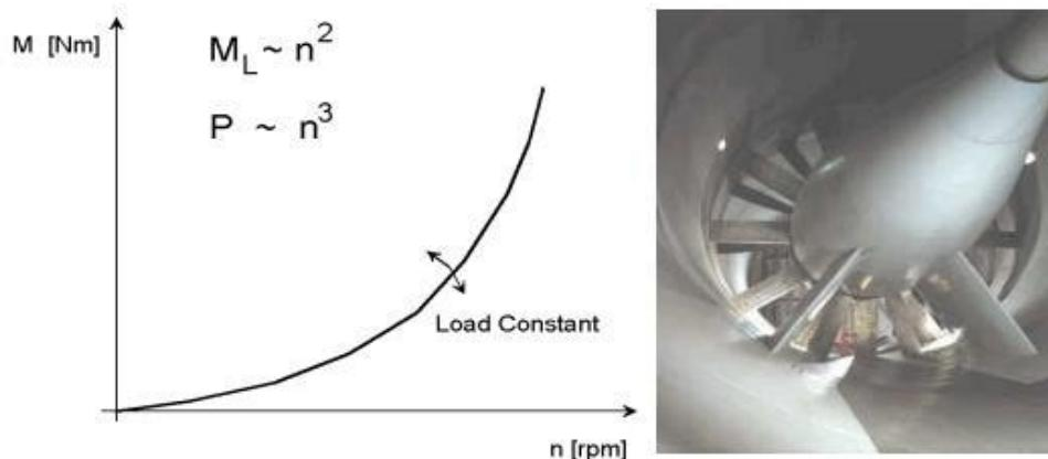
**Slika 5.10** Momentna karakteristika ventilatora [3]
