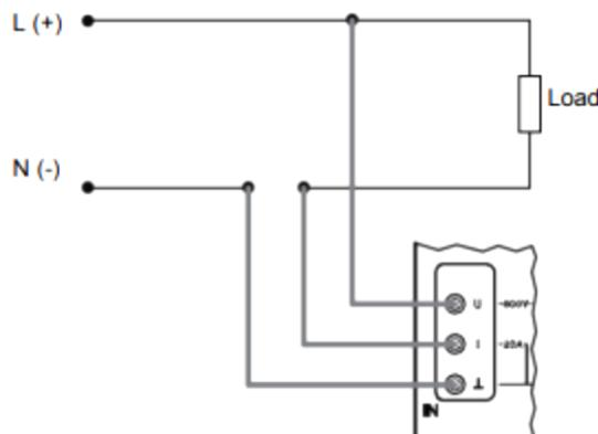
**Slika 4.11 Shema spajanja multimetra za AC, DC krug [3]**
