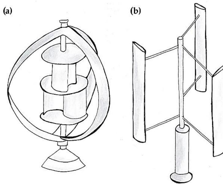
**Slika 6.16** Dva modela malih vjetroturbina za provedbu isplativosti: (a) TKV3, (b) Aeolos V [23]
