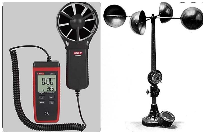
**Slika 3.2** Anemometar za ručnu primjenu i onaj koji se instalira na krov ili neku povisenu podlogu
