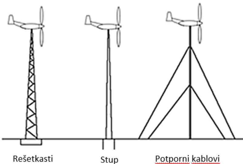
**Slika 3.12** Tri tipa tornjeva samostojećih malih vjetroturbina [24]
