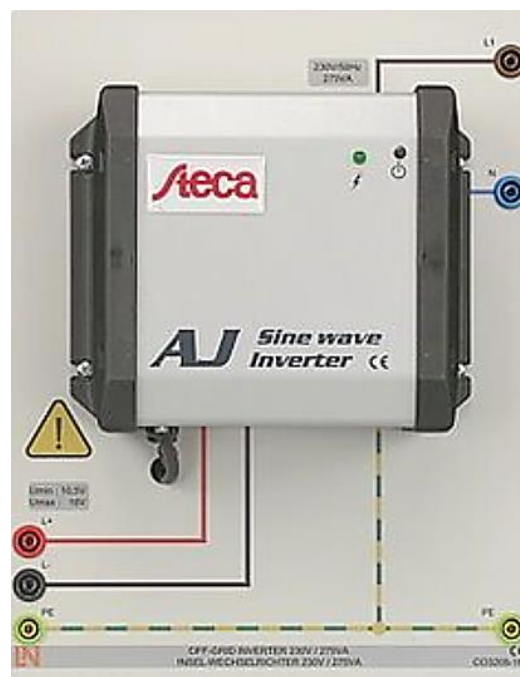
Slika 4.4 Izvanmrežni pretvarač 230 V, 275 VA [3] i [4]
