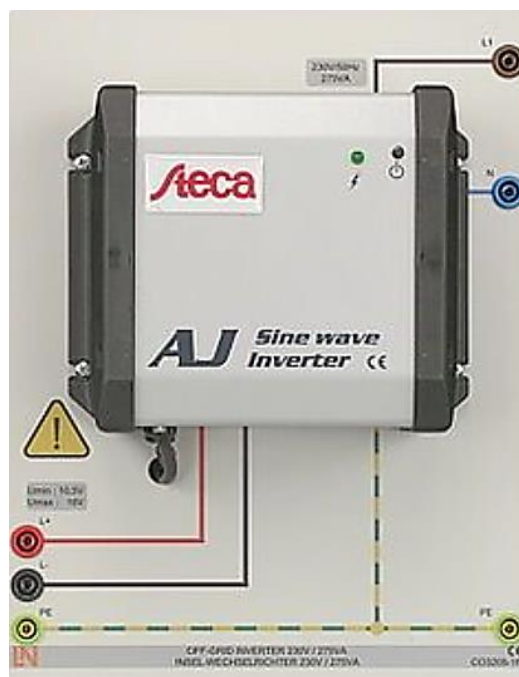
Slika 4.4 Izvanmrežni pretvarač 230 V, 275 VA [3] i [4]
