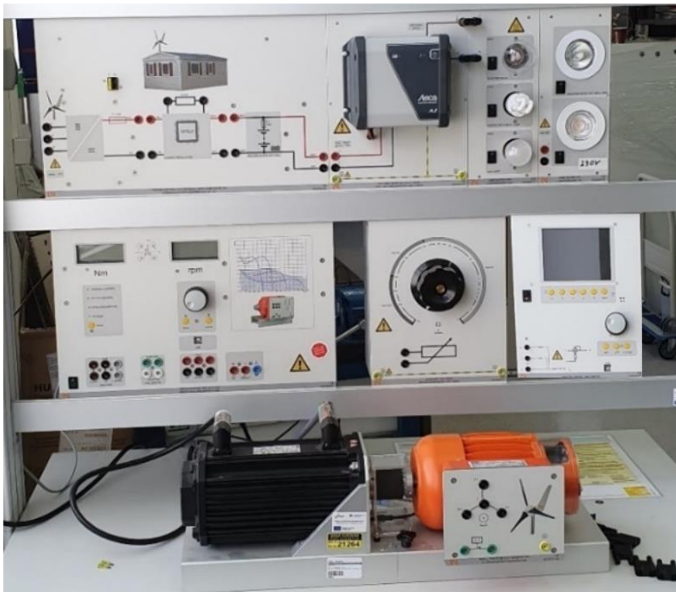
Slika 4.1 Simulator male vjetroelektrane [3] i [4]
