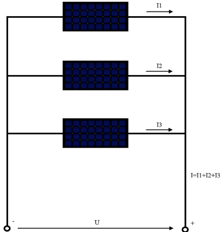
*Slika 3.3.3 Fotonaponski moduli spojeni paralelno*
