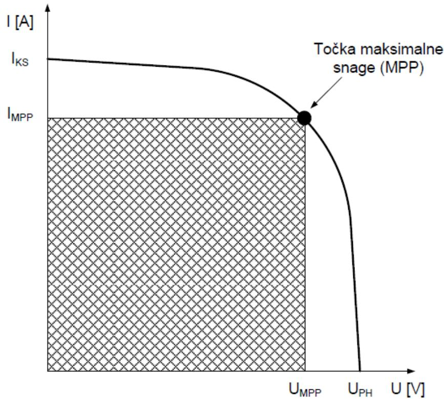
Slika 3.1.2 U-I karakteristika fotonaponske čelije
