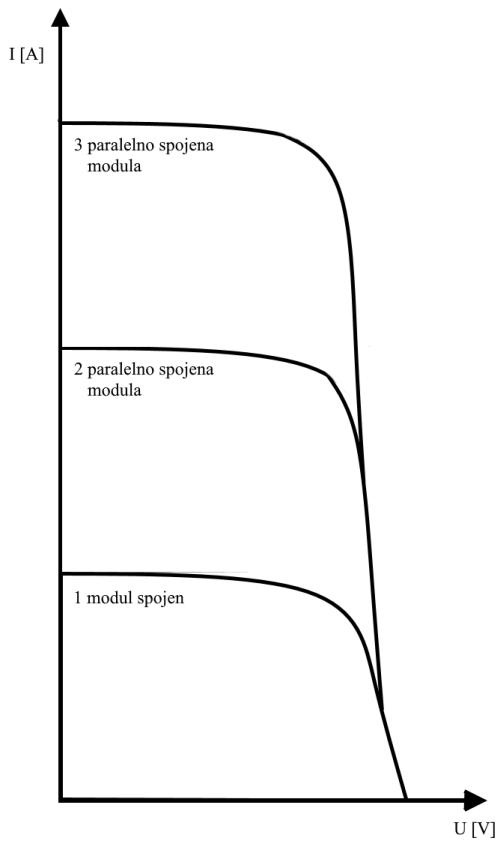
*Slika 3.3.4 Strujno naponska karakteristika paralelno spojenih fotonaponskih modula*
