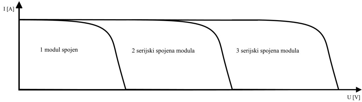
*Slika 3.3.2 Karakteristika serijski spojenih fotonaponskih modula*
