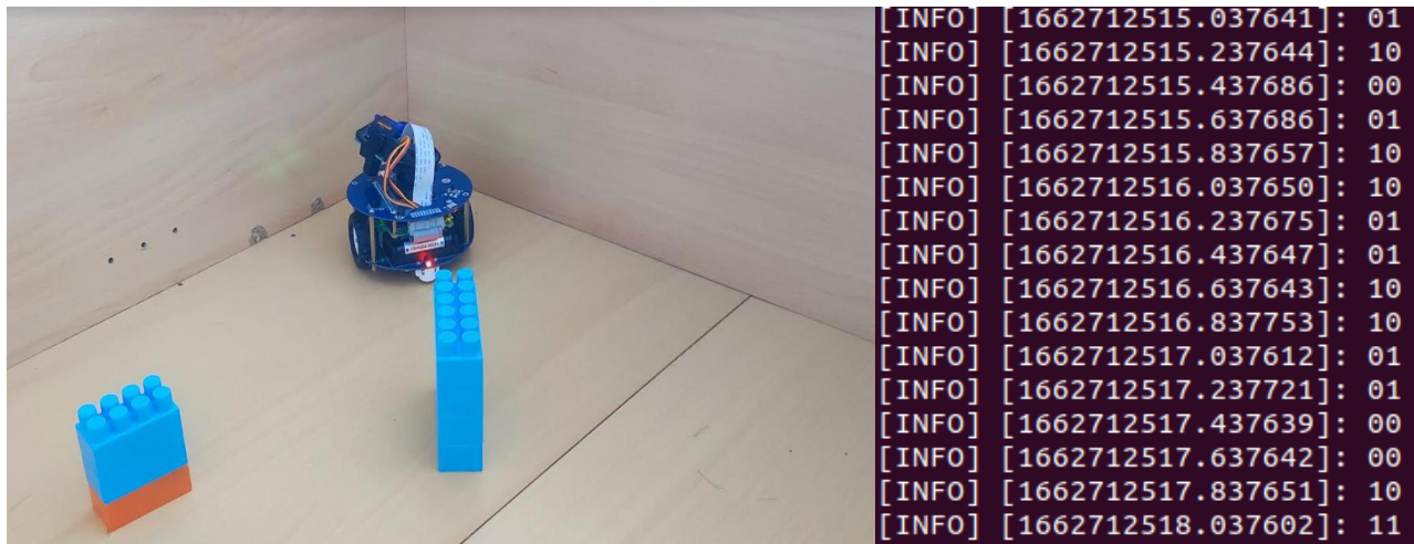
Slika 5.4 Greška prilikom određivanja smjera kretanja za rubove
