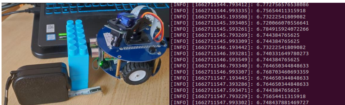
Slika 5.3 Greška prilikom računanja udaljenosti ultrazvučnog senzora
