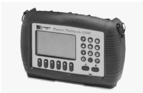
2.14. Ručni harmonijski analizator [1]
