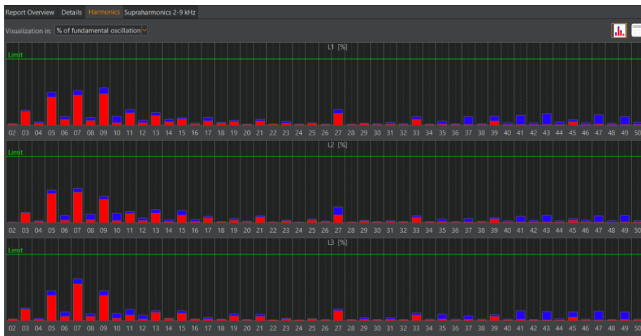
Slika 4.9. Prikaz vrijednosti harmonika napona po fazama
