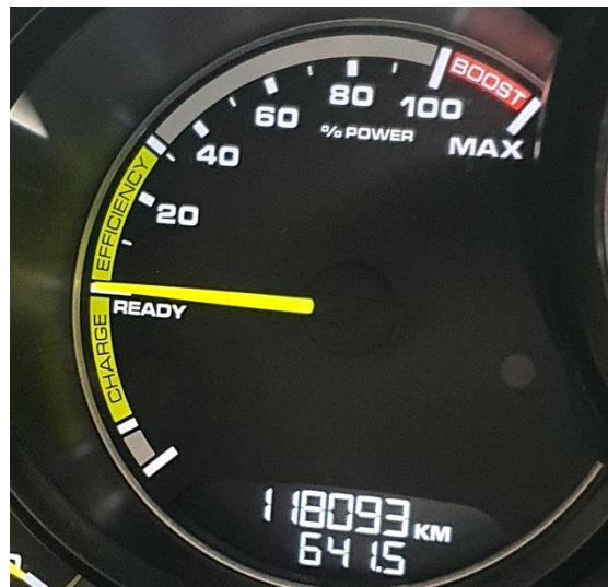
Slika 6.10 Pokazivač postotka stiskanja papučice gasa
