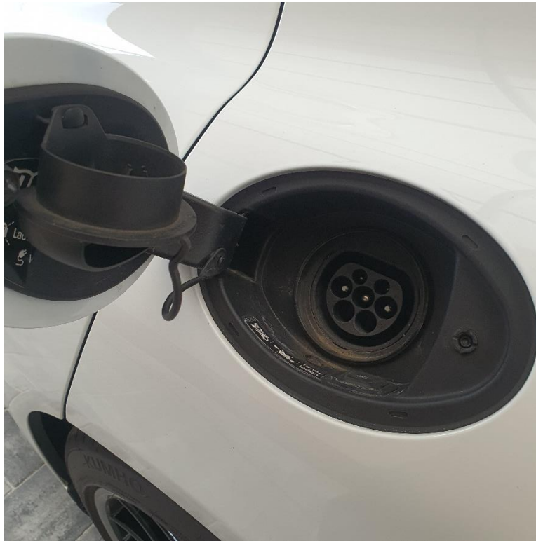
Slika 6.2 Type 2 utičnica na vozilu
