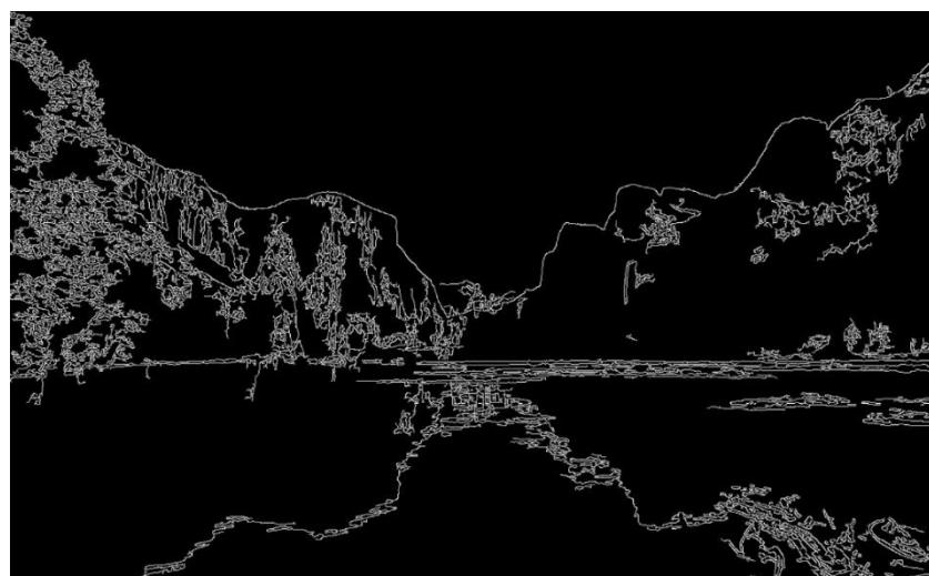
**Slika 4.8.** Fotografija jezera nakon primjene Canny Edge Detection algoritma s parametrima  $10, 245$
