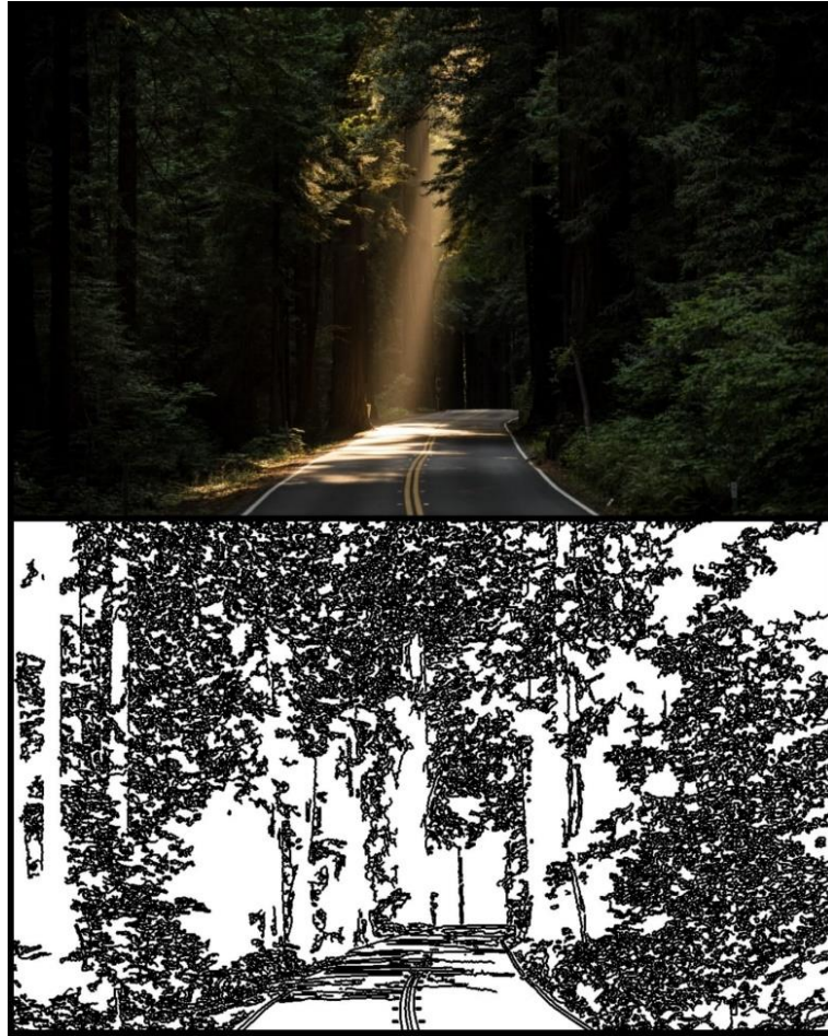
Slika 4.14. Fotografija ceste [18] prije i poslije primjene algoritma Canny Edge Detection
