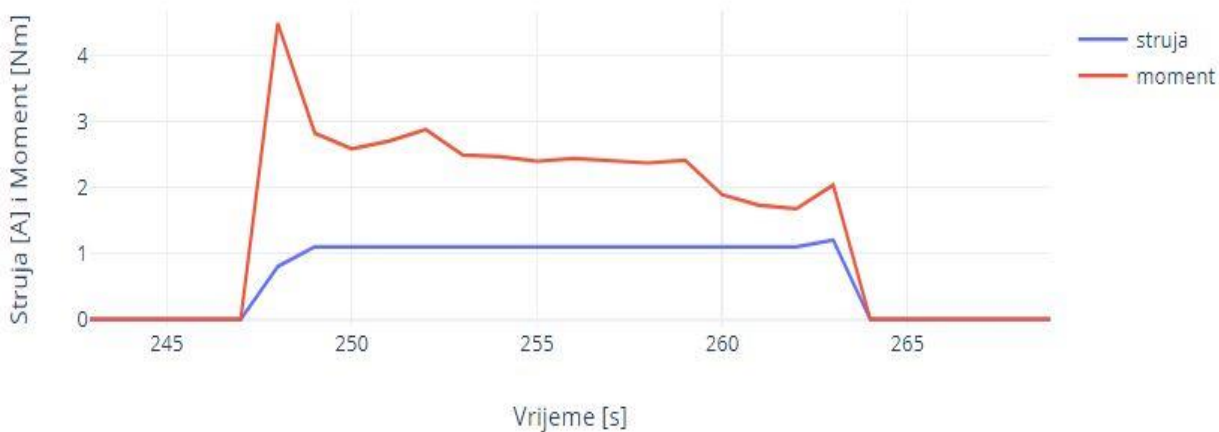
Slika 4.3 – Grafički prikaz struje i momenta sa rampom 5s i teretom.
