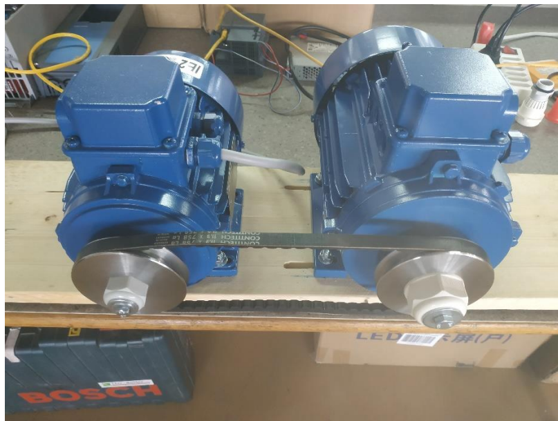
Slika 2.1 – Prikaz dva asinkronog motora (0.75kW i 2.2kW).
