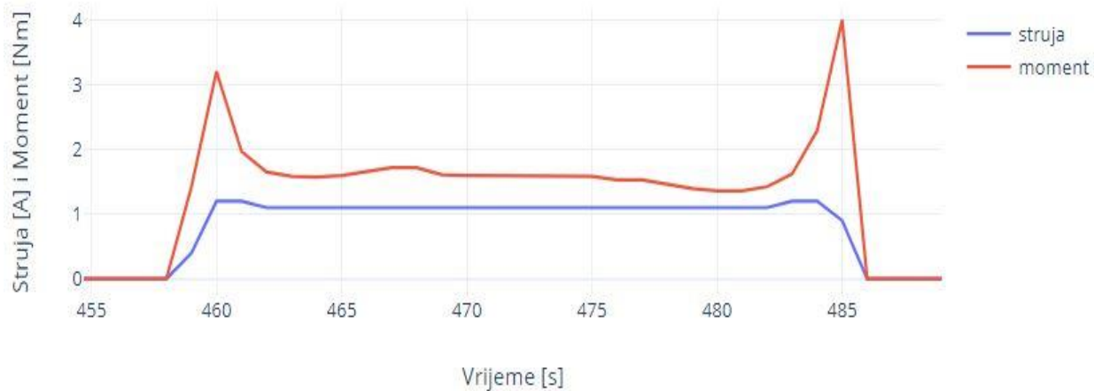
Slika 4.4 – Grafički prikaz struje i momenta sa rampom 10s bez tereta.
