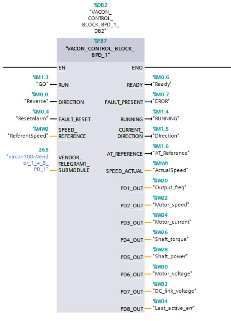
*Slika 3.9 – Funkcijski blok za upravljanje motorom.*
