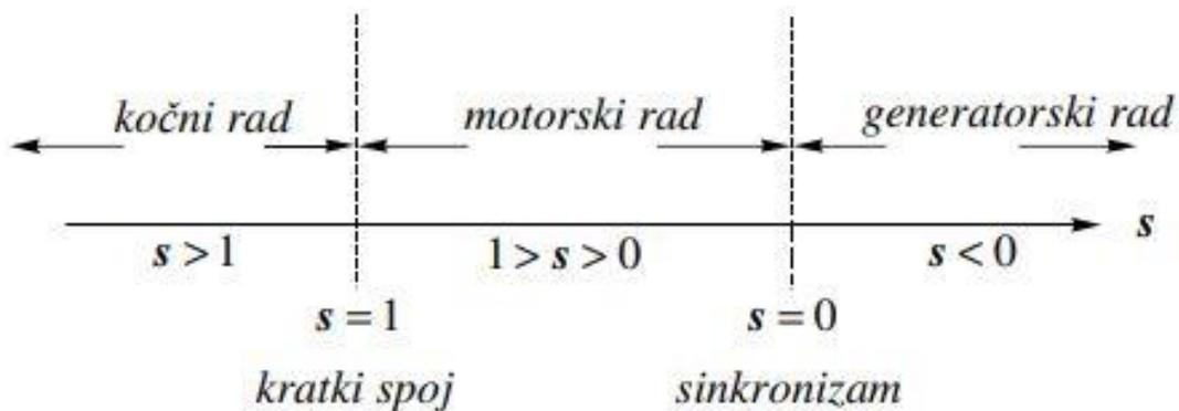
**Slika 2.2** – Prikaz režima rada elektromotora i vrijednosti klizanja [1]
