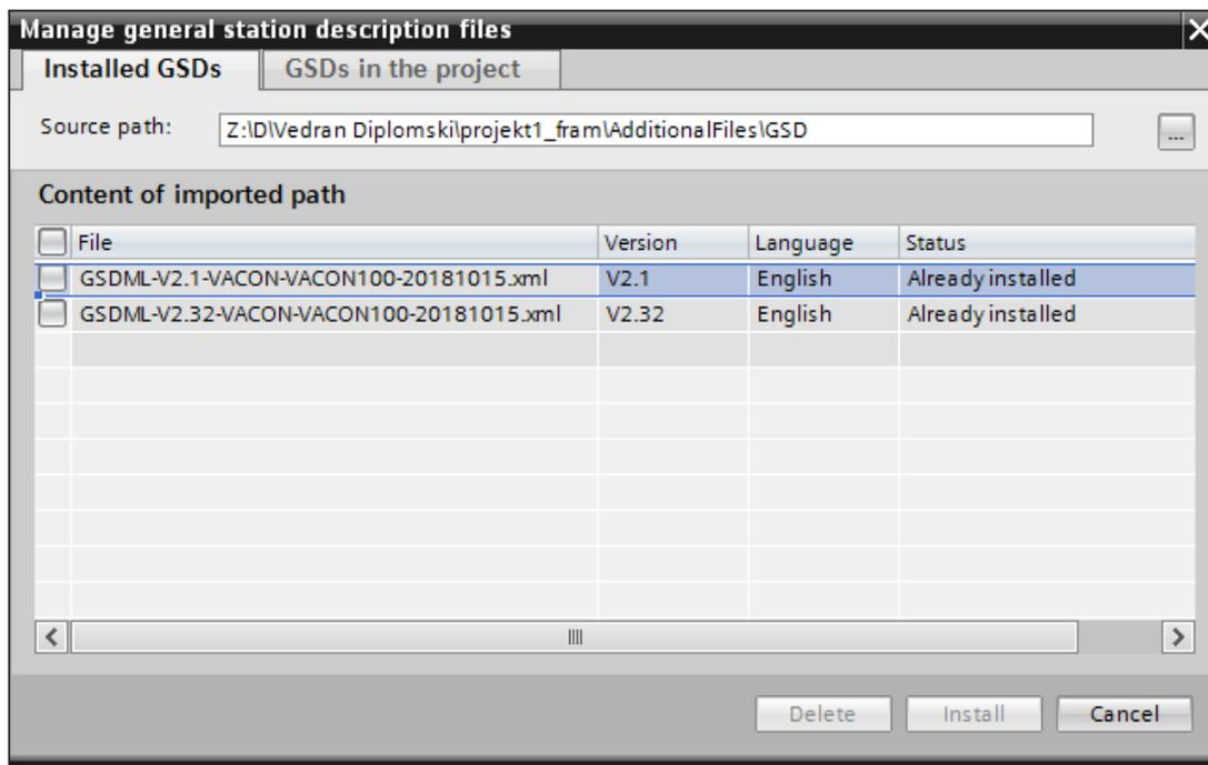
*Slika 3.7 – Prikaz dodavanja GSD datoteke Vacon frekventnog pretvarača.*
