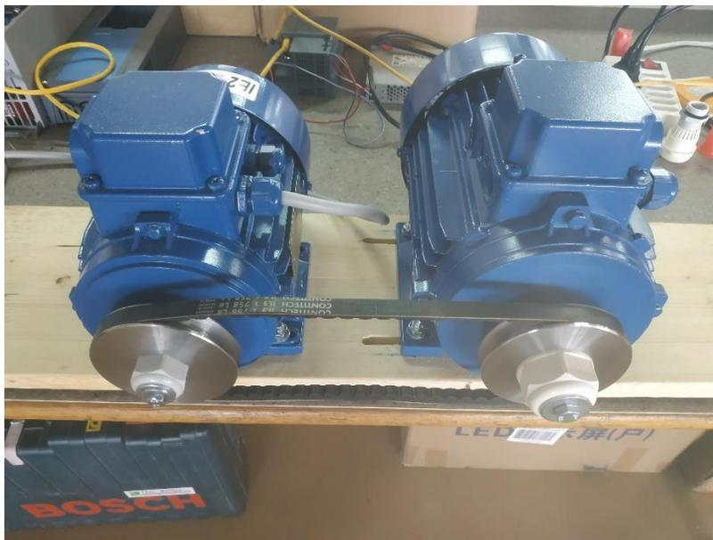
Slika 2.1 – Prikaz dva asinkronog motora (0.75kW i 2.2kW).
