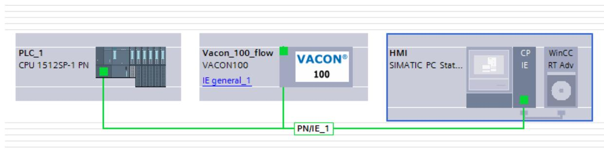
*Slika 3.8 – Prikaz mreže uređaja spojene Profinet komunikacijom.*
