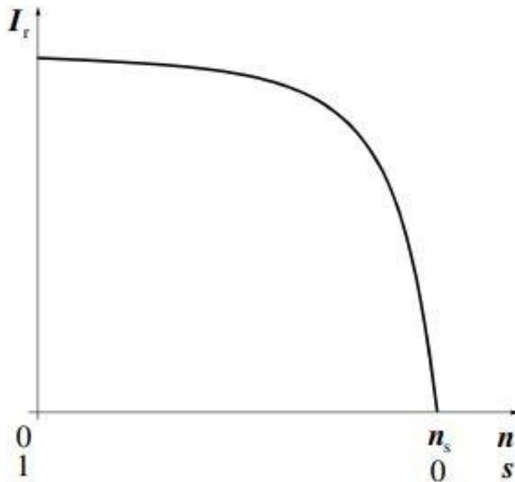
*Slika 2.4 – Karakteristika brzine vrtnje asinkronog motora [1]*
