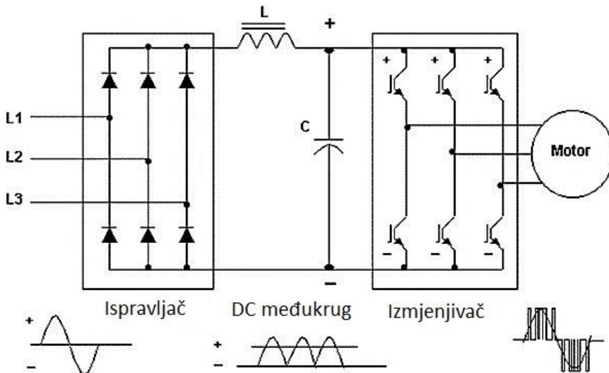
*Slika 2.7 – Prikaz sheme spoja frekventnog pretvarača sa istosmjernim međukrugom. [5]*
