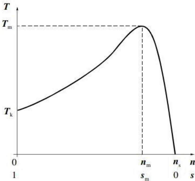
Slika 2.3 – Momentna karakteristika asinkronog motora [1]
