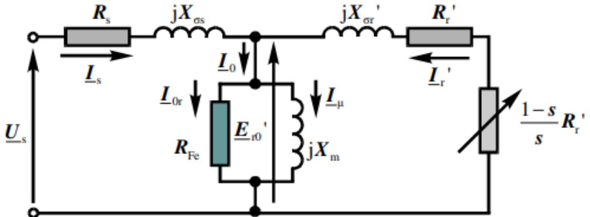
Slika 2.5 – Nadomjesna shema asinkronog motora [1]
