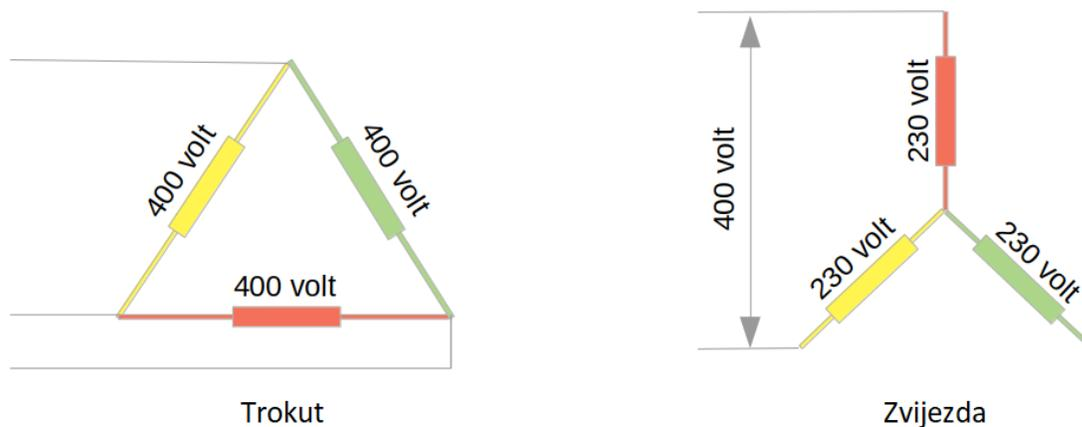
Slika 2.6 – Prikaz vrste spoja namota trofaznog asinkronog motora. [3]
