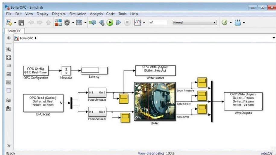
*Slika 2.4. Model sklopovlja korištenjem Simulink blokova
