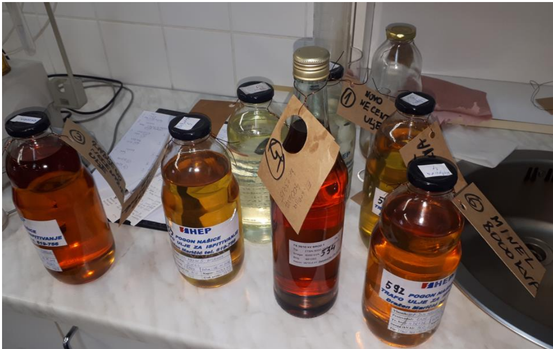
Sl. 3.13. Uzorci transformatorskog ulja
