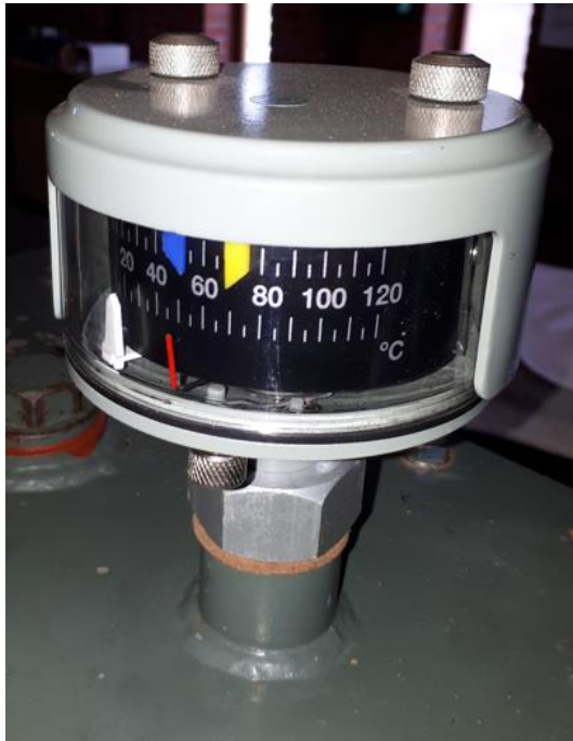
Sl. 3.16. Bimetalni termometar za vertikalnu ugradnju
