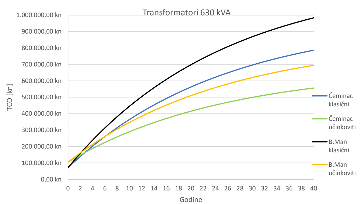
Sl. 6.1. Usporedba isplativosti zamjene transformatora 630 kVA
