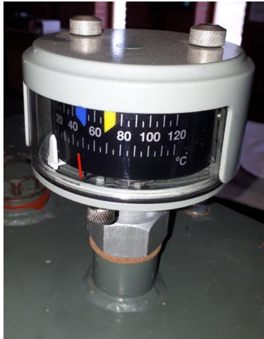
Sl. 3.16. Bimetalni termometar za vertikalnu ugradnju
