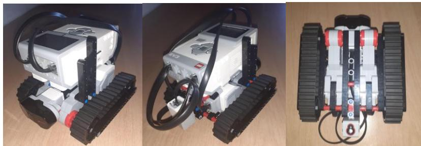
**Sl.5.4.** Prikaz treće inačice agenta. U usporedbi s drugom inačica, infracrveni senzor je još uvijek na prednjoj strani (lijevo), ali više ne utječe na centar mase. Senzor boja je premješten na stražnju stranu (sredina). Cijela konstrukcija je viša od prošlih inačica. Konstrukcija dna je jednostavnija (desno), ali puno čvršća u usporedbi s prošlim inačicama.
