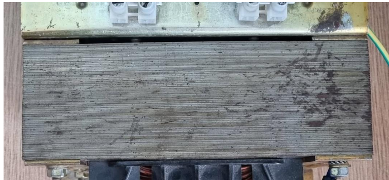
Slika 5.12. Limovi transformatora, pogled od gore
