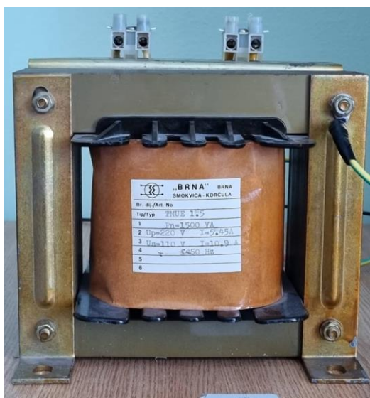
Slika 4.1. Transformator „BRNA TMUE 1.5“
