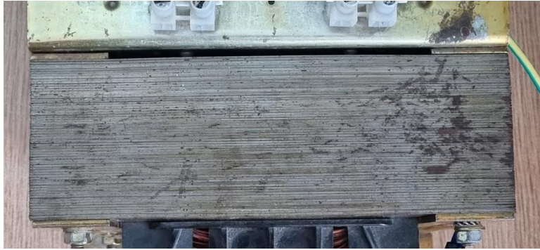
Slika 5.12. Limovi transformatora, pogled od gore
