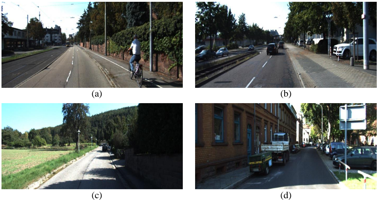
Sl. 2.6. Prikaz slika iz KITTI baze podataka snimljenih u različitim scenarijima: (a) gradska, ravna cesta, isprekidane linije vozne trake, sjena (b) gradska, ravna cesta, dobra vidljivost linija voznih traka (c) urbano područje, ravna cesta, slaba vidljivost linija voznih traka, sjena (d) gradska, ravna cesta, ne postoje linije vozne trake, sjena
