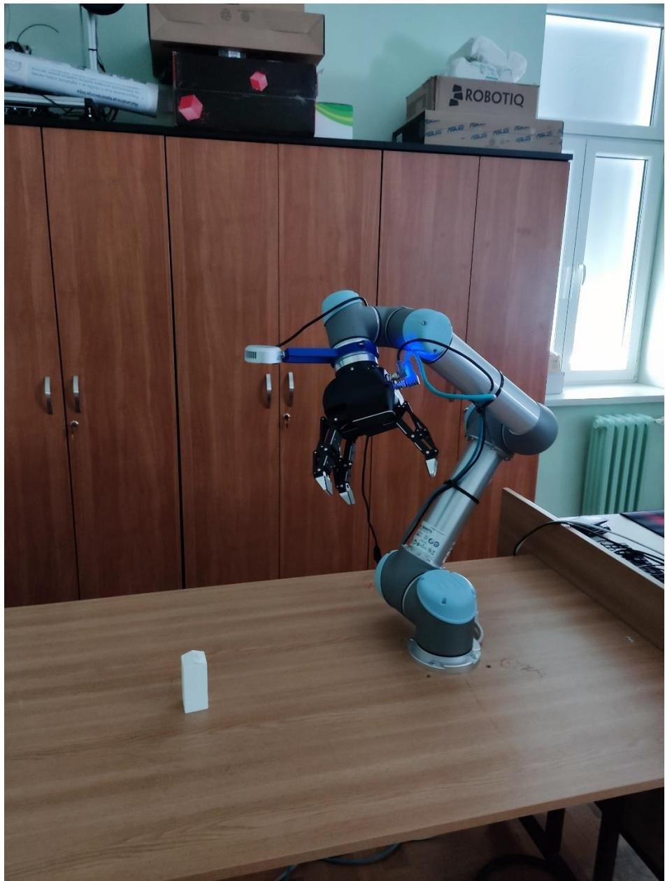
**Slika 6.2.** Inicijalni položaj robotskog manipulatora pri skeniranju scene
