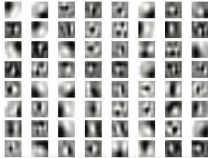
Slika 3.4. Naučeni konvolucijski filteri GQ-CNN mreže
