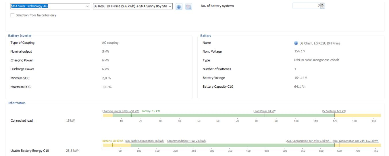
Slika 5.6. Model instalirane baterijske naprave
