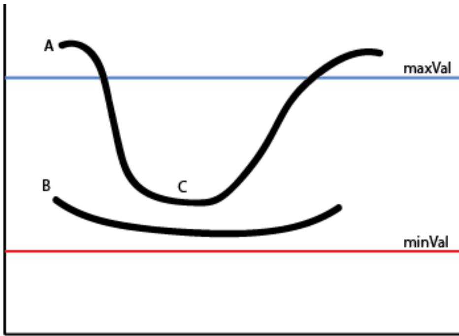
Slika 4.15. Primjer četvrтog koraka *Canny* algoritma
