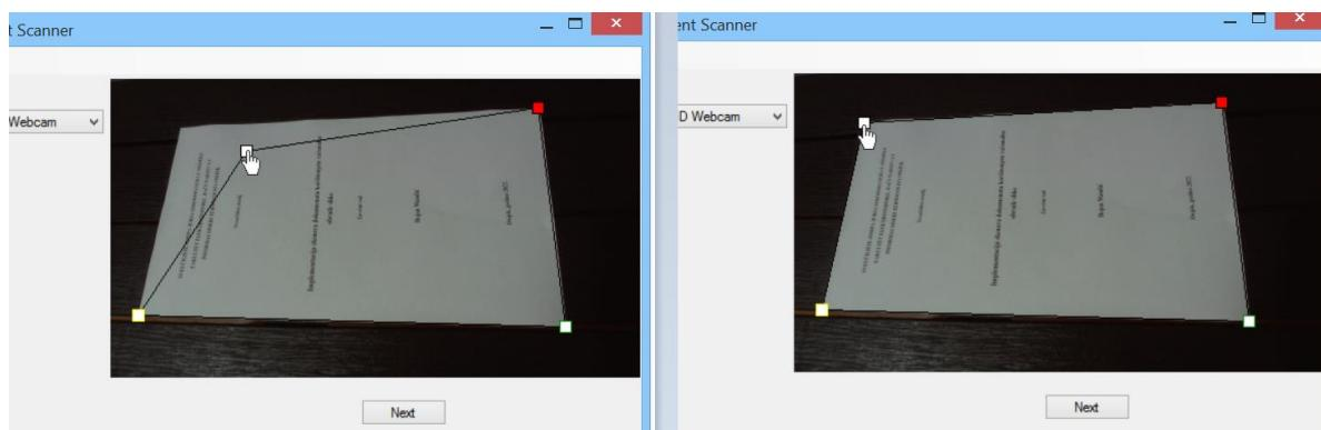
Slika 4.18. Primjer ručnog ispravljanja pogrešno detektiranog obrisa papira
