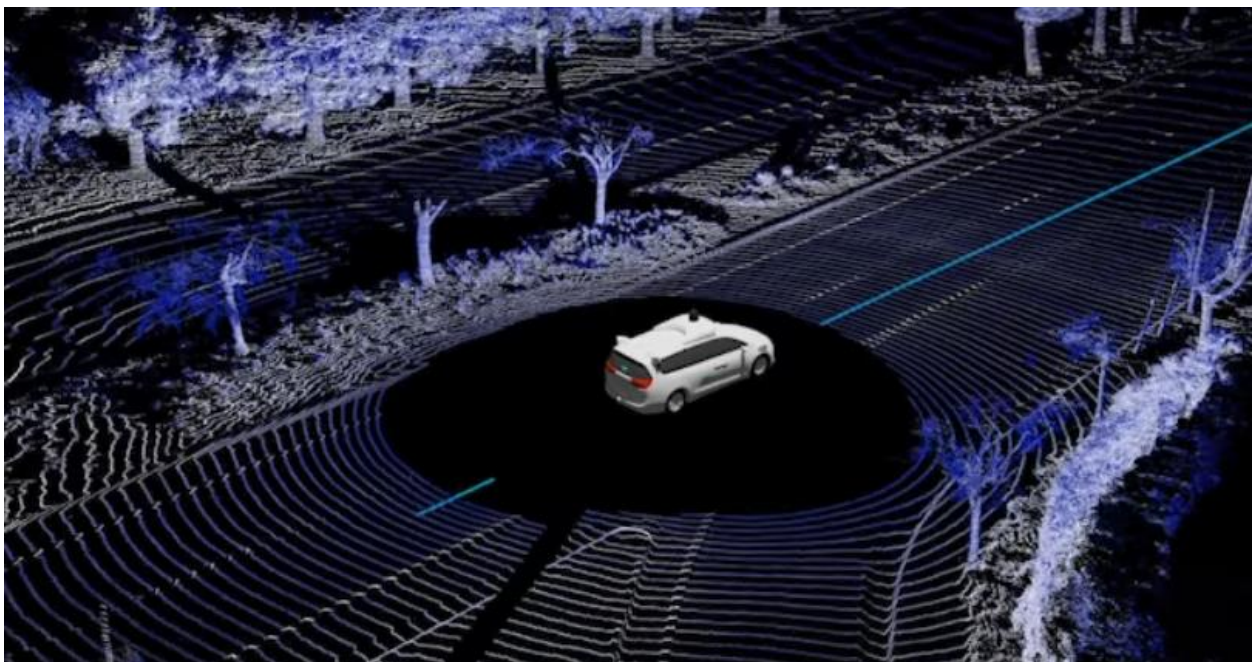
Slika 2.2. Korištenje LIDAR-a za kreiranje 3D slike okruženja [31].
