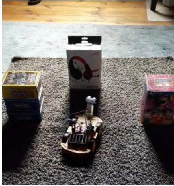
Slika 5.1. Model autonomnog vozila u trenutku skretanja nadesno kako bi izbjeglo prepreke.
