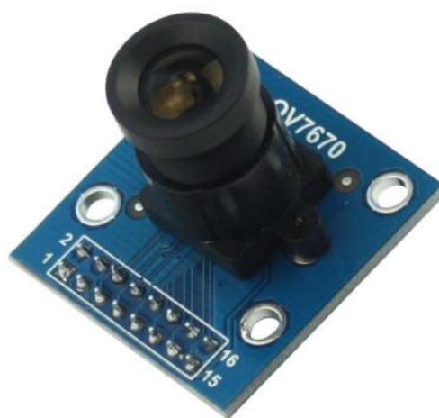
Slika 4.5. Prikaz kamere CMOS OV7670 [42].
