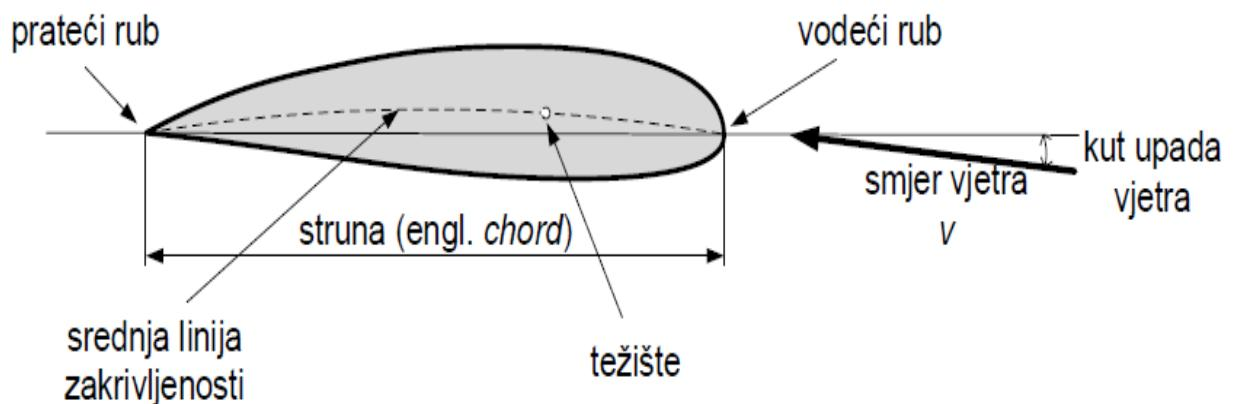
Slika 4.14. Dijelovi lopatice i njezina aerodinamička svojstva [6]
