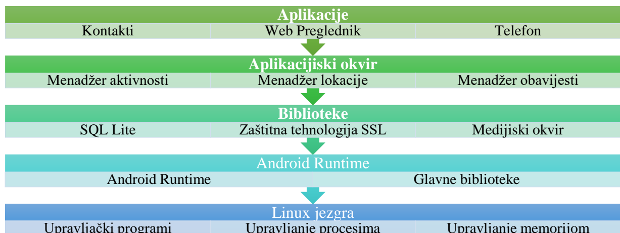
Slika 2.2. Arhitektura Android sustava [3]
