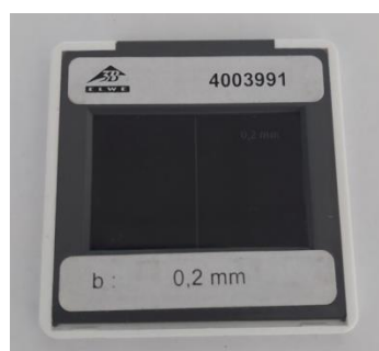
Slika 6.12. Prikaz korištene pukotine širine 0,2 mm
