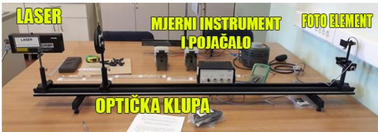
Slika 6.1. Prikaz postojećeg eksperimentalnog postava
