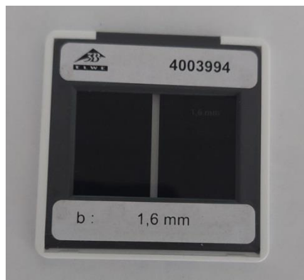
Slika 6.21. Prikaz korištene pukotine širine 1,6 mm
