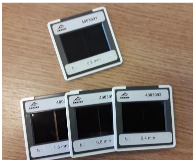
Slika 6.3. Prikaz pukotina različitih širina koje se mogu koristiti na postojećem postavu
