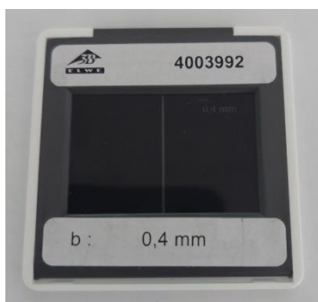
Slika 6.15. Prikaz korištene pukotine širine 0,4 mm
