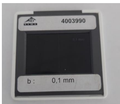
Slika 6.9. Prikaz korištene pukotine širine 0,1 mm
