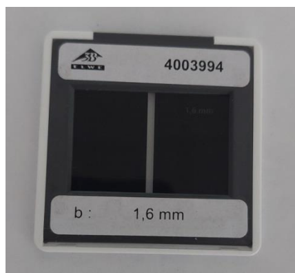
Slika 6.21. Prikaz korištene pukotine širine 1,6 mm
