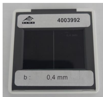
Slika 6.15. Prikaz korištene pukotine širine 0,4 mm
