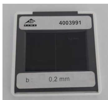
Slika 6.12. Prikaz korištene pukotine širine 0,2 mm
