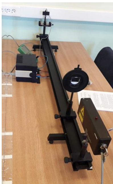
Slika 6.2. Prikaz postojećeg eksperimentalnog postava iz smjera lasera
