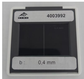
Slika 6.15. Prikaz korištene pukotine širine 0,4 mm
