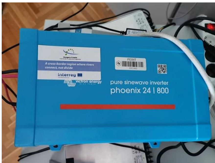
Slika 4.7. Phoenix 24/800 – otočni izmjenjivač
