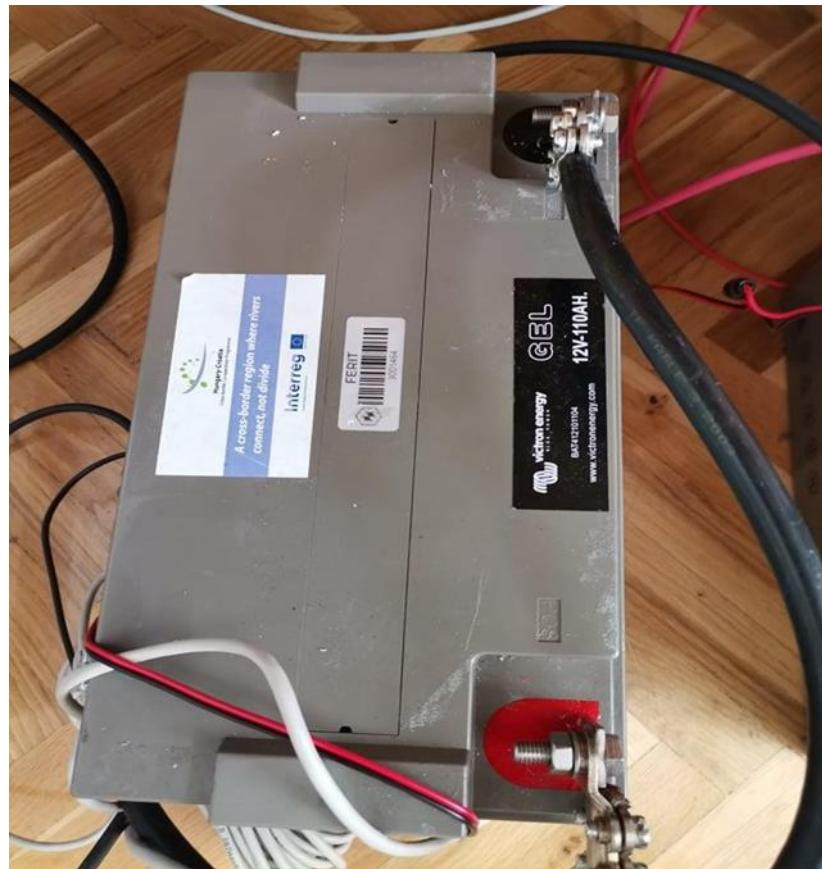
Slika 4.10. Victron Energy GEL baterija – 12 V, 110 Ah
