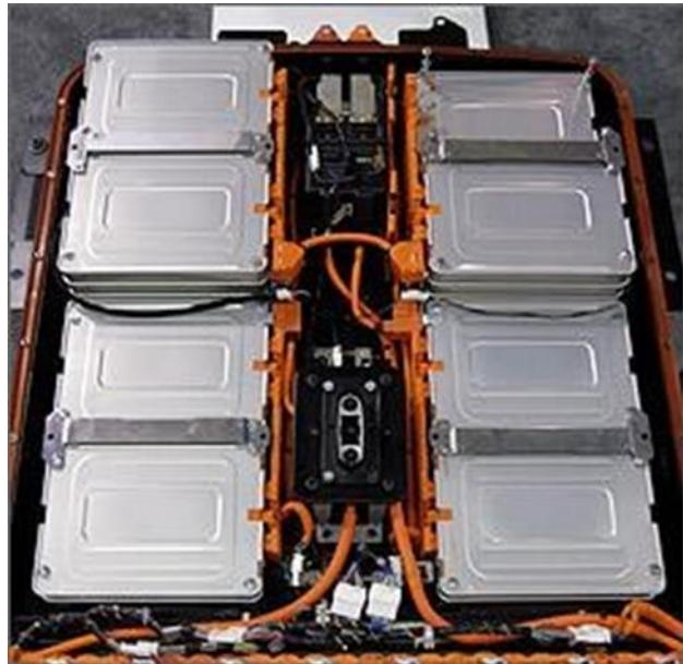
*Slika 3.8. Li – ion baterije za električno vozilo [31]*
