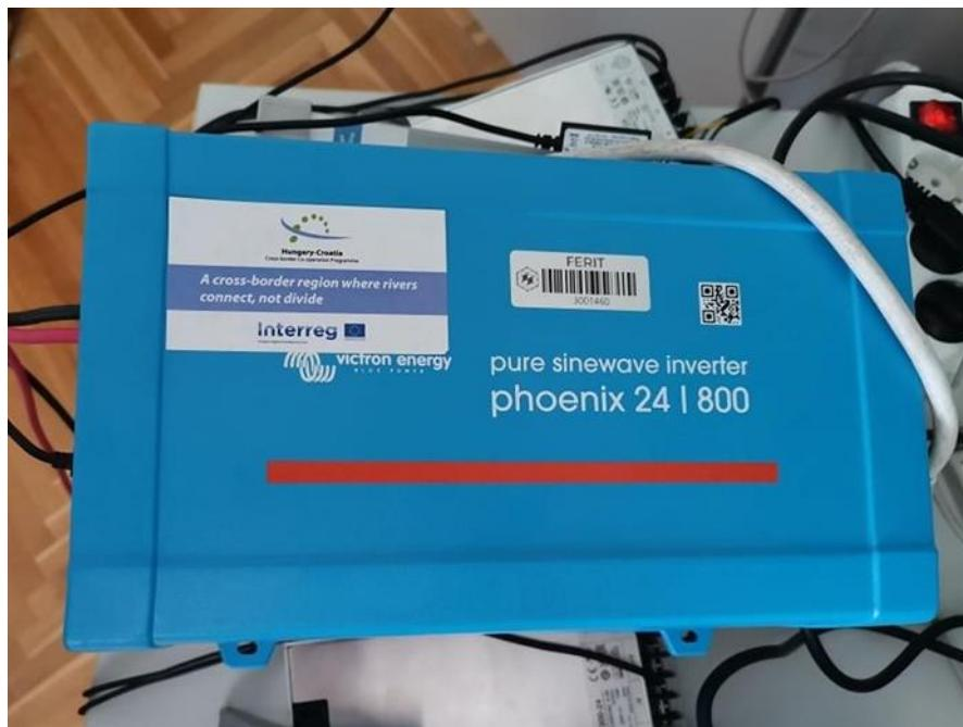
Slika 4.7. Phoenix 24/800 – otočni izmjenjivač
