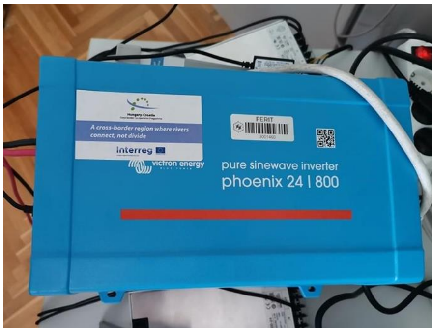
Slika 4.7. Phoenix 24/800 – otočni izmjenjivač
