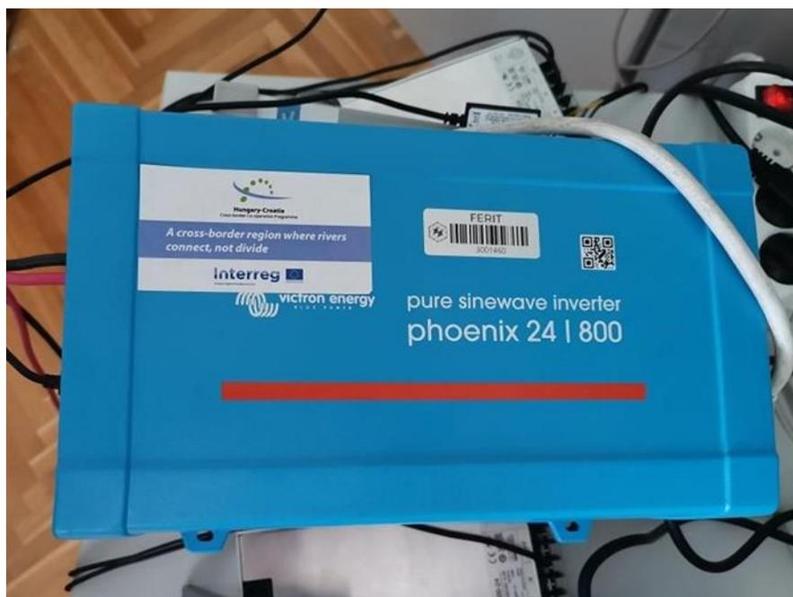
*Slika 4.7. Phoenix 24/800 – otočni izmjenjivač*
