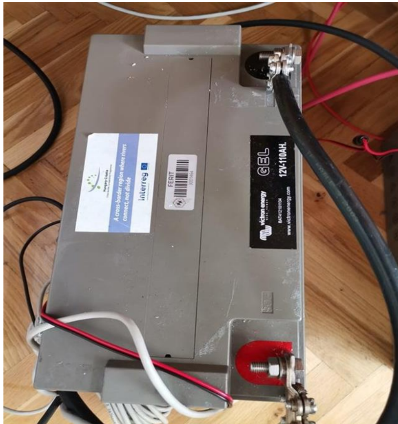
Slika 4.10. Victron Energy GEL baterija – 12 V, 110 Ah
