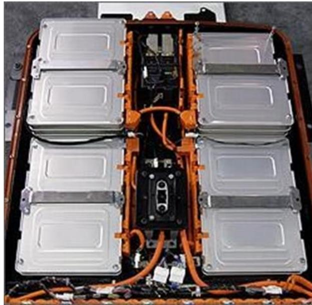
*Slika 3.8. Li – ion baterije za električno vozilo [31]*
