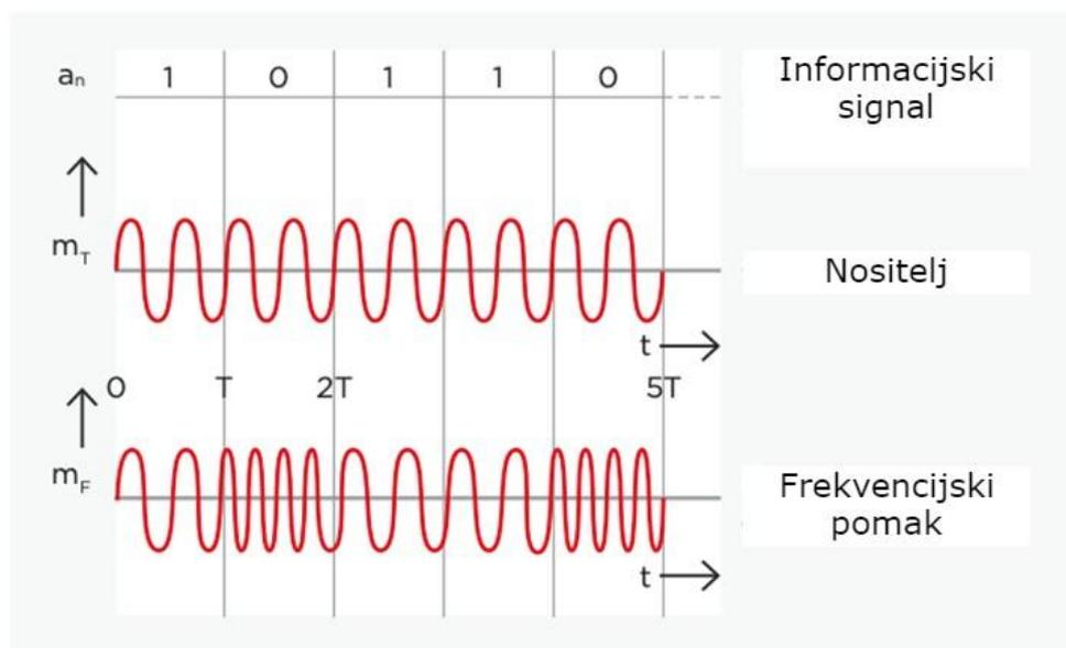
Sl. 4.4. Frekvencijska modulacija i signal u RF [5]
