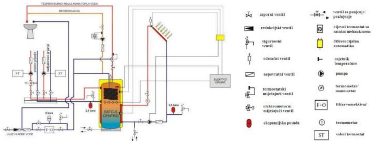
Slika 2.11. Sustav za pripremu PTV-a i grijanje prostora s protočnim grijačem (izmjenjivačem) [1]
