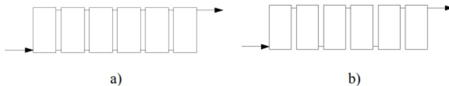
Slika 2.3. Spojevi kolektora a) paralelni b) serijski [1]
