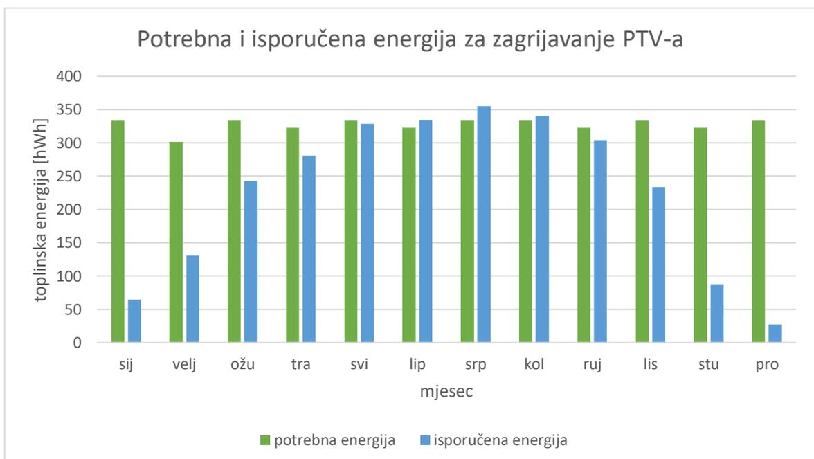
Slika 4.2. Omjer potrebne i isporučene energije vakuumskim kolektorima
