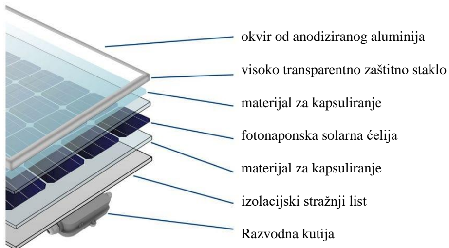
Slika 3.11, Prikaz sastava fotonaponske ćelije [24]
