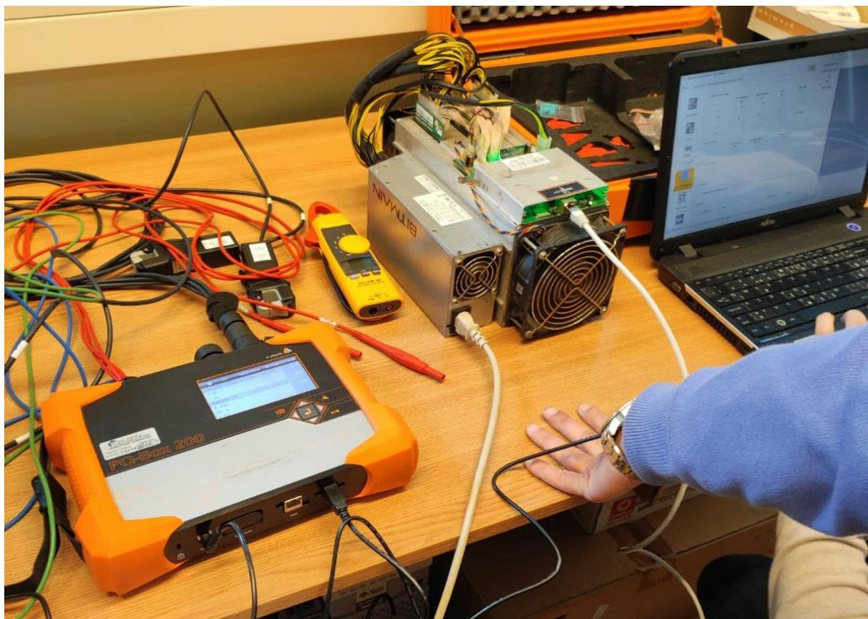
**Slika 6.1.** Mjerjenje utjecaja ASIC sklopolvlja na kvalitetu električne energije u zgradi FERIT-a
