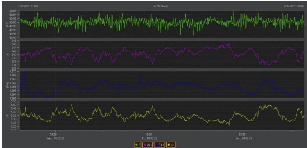
**Slika 6.19.** Promjena frekvencije, napona, snage i struje u mjerenu periodu u drugom tjednu mjerjenja
