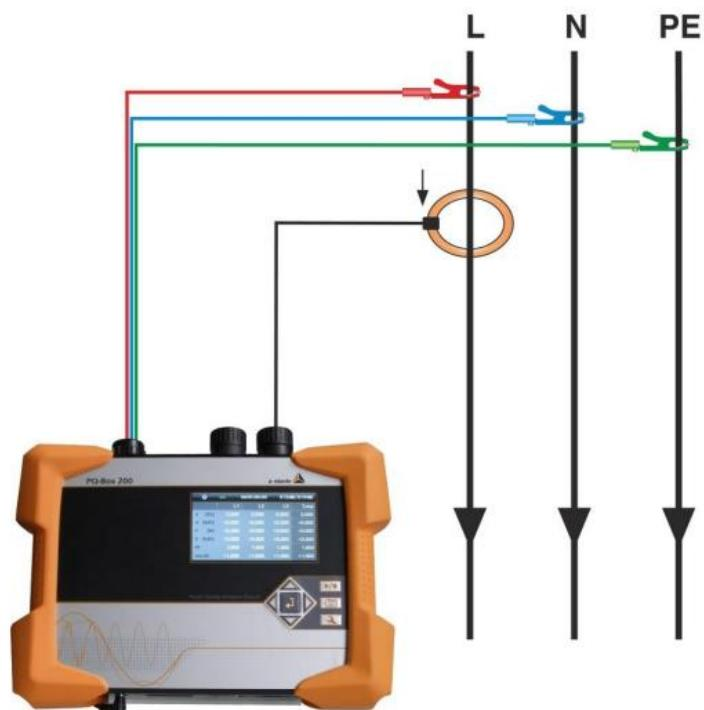
**Slika 6.2.** Shema spajanja PQ-box 200 uređaja [10]
