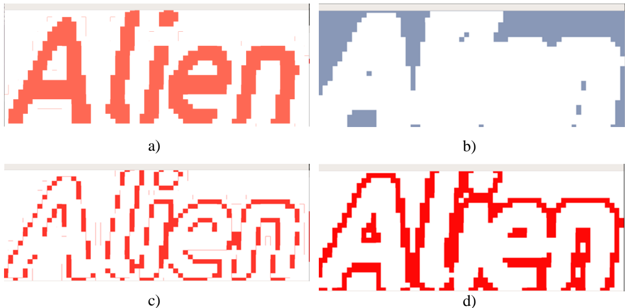
Slika 3.4. Segmentacija slike teksta primjenom algoritma k srednjih vrijednosti
