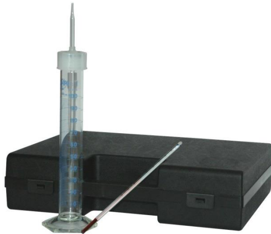
Slika 3.11 Mjerenje se izvodi sa cilindrom i klipom (napunjen određenim uzorkom vina) koji se nalazi u cilindru, cilindar se promućka te se iz njega izbacuje volumen uzorka koji je proporcionalan volumenu rastvorenog CO 2 , volumen vina, koji je ostao uz pomoć korekcijskih tablica za temperaturu uzorka, određuje sadržaj CO 2 [30] [31]
