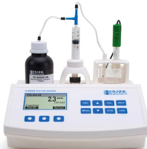
Slika 3.10 Mini titrator za mjerenje sumpor dioksida (mjeri koncentraciju slobodnog i ukupnog su sumpornog dioksida u vinu) [27]
