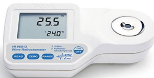
Slika 3.4 Vinski refraktometar marke HANNA oznake HI-96813, mjeri indeks loma svjetlosti i prikazuje količinu etanola na temelju uzorka (kapljice) [11]
