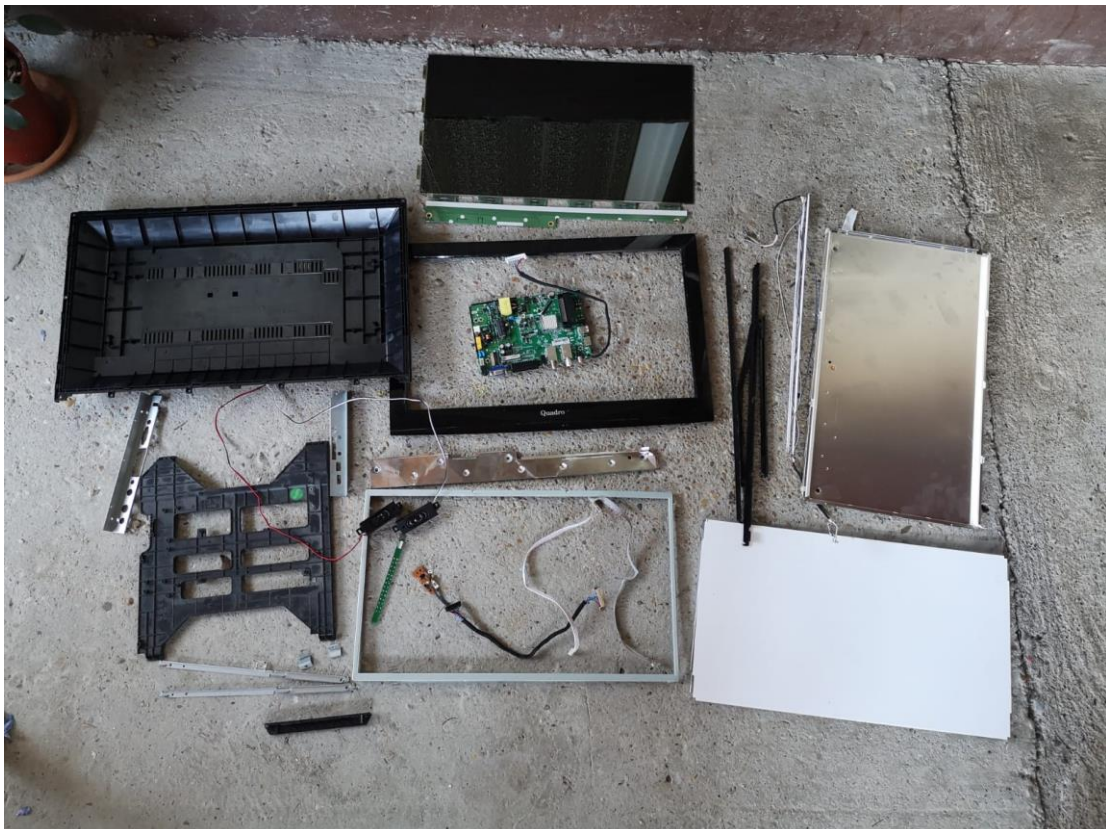
Sl. 3.5 LCD Quadro LCD-22AB1 poslije rastavljanja
