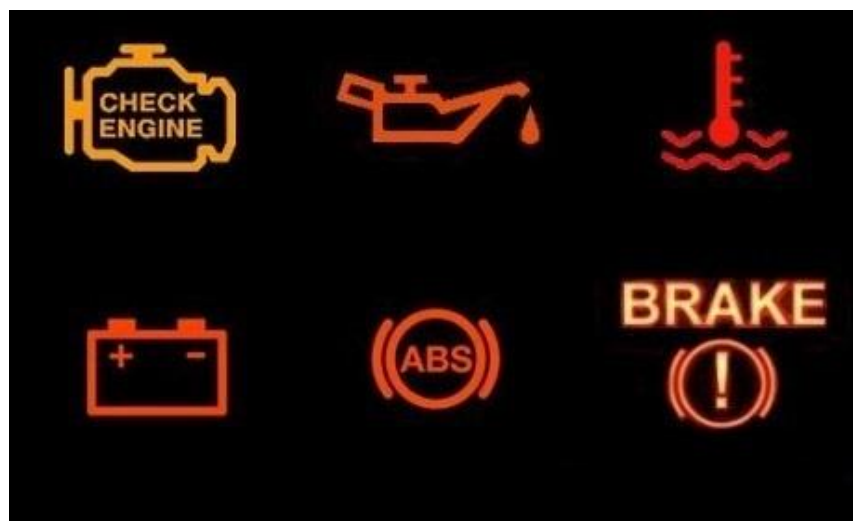
Slika 3.3 Prikaz MIL indikatora [9]
