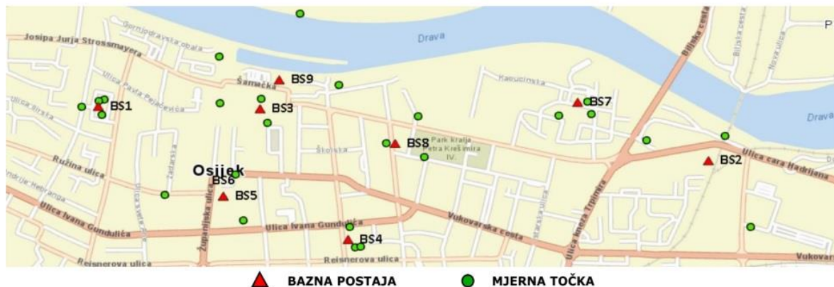
Sl. 5.1. Bazne postaje i mjerne točke provedenog testiranja u gradu Osijeku [22]
