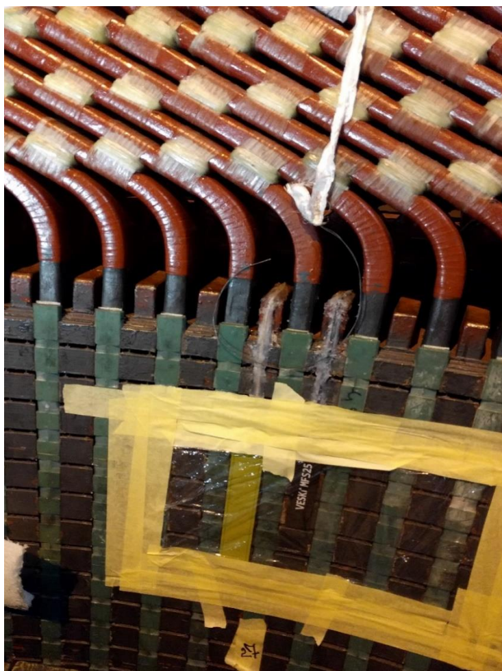
Slika 4.1. Pozicioniranje senzora magnetske indukcije
